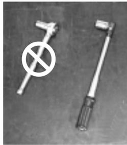
**Torquímetro de SDI:** Este torquímetro de grado industrial más alto, tiene un mecanismo de transmisión de 1/2", un botón / palanca para cambiar la dirección, y un "clic" que se escucha. El "clic" indica al operador para no mover más el torquímetro contra el tornillo cuando el nivel apropiado de esfuerzo de torsión ha sido alcanzado. Moviéndolo hacia la derecha le permitirá asegurar los tornillos. Moviéndolo hacia la izquierda le permitirá aflojar los tornillos.
