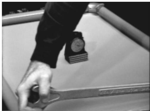
Levante el tensiómetro para leer la esfera en la dirección entre los rodillos más cortos #1 & #2. Verifique que los niveles de tensión sean iguales en ambas direcciones, con una diferencia no mayor de 2 N/cm entre ellos. De acuerdo a estos resultados, puede ser que Ud. necesite modificar la rotación de los rodillos #1 & #2, ya sea más o menos.
