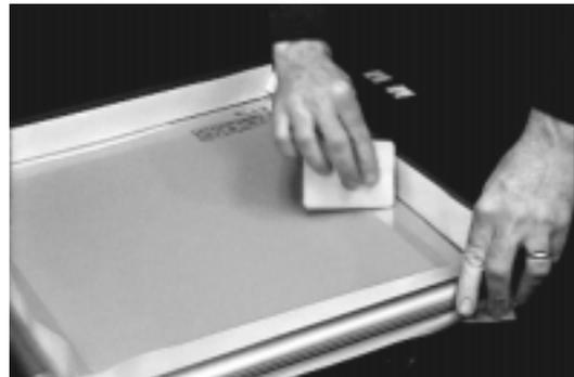
Newman Fabric Protectors™ (Protectores de Malla para los marcos Newman) son cubiertas plásticas que se fijan alrededor del rodillo o caja viga para proteger la malla. Estos no son afectados por solventes o tintas. Ellos simplemente se insertan en el rodillo o la caja viga y se mantienen en lugar con la cinta.
