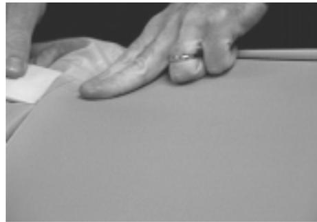
Una vez más, coloque el tensiómetro sobre la malla, en el centro del marco, para leer de acuerdo a la dirección en la que se va a retensar. Gire el rodillo hasta llegar al próximo nivel de tensión determinado por la Tabla apropiada para tensar mallas, o de acuerdo al nivel determinado por Ud., para los requerimientos de su planta. Este mismo procedimiento puede ser seguido para retensiones subsecuentes.
